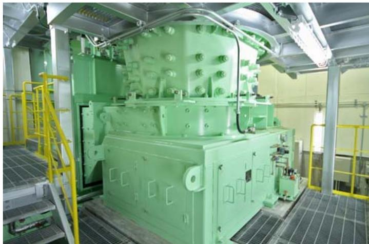
二次破碎機は、一次破碎機で粗破碎された不燃・粗大ごみをさらに細かく砕く機械です。この後、破碎物から鉄などの資源が回収されていきます。
